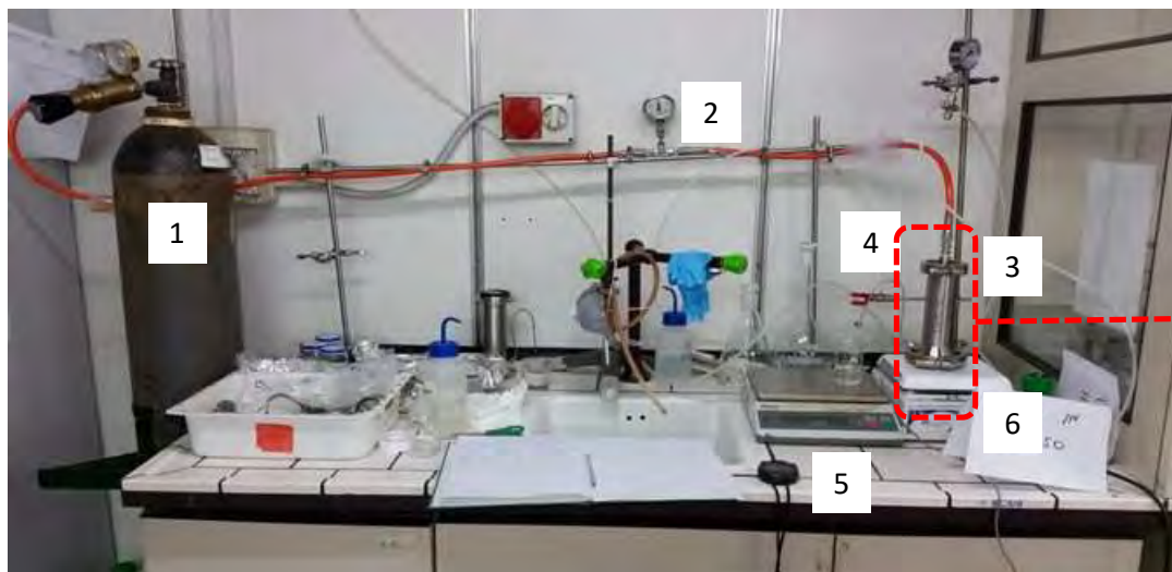
Impianto da banco di nanofiltrazione: 1. Bombola di azoto; 2. Manometro per la misura della pressione in ingresso; 3. Cella in acciaio inox contenente la membrana; 4. Tubo collettore per la raccolta del permeato; 5. Bilancia digitale; 6. Agitatore magnetico
